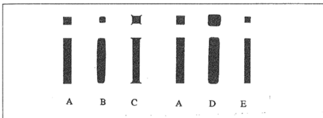
FIG. 2.6 - Les caractères doivent être redessinés en fonction de la technologie employée: en A, le caractère théorique; en B ce qu'il donnerait en photocomposition; en C, la façon dont il doit être redessiné pour qu'une photocomposeuse donne le dessin A; en D, ce que donnerait une machine à écrire à partir de A; en E le caractère redessiné pour qu'une machine à écrire donne le caractère A (d'après FRUTIGER [33]).
